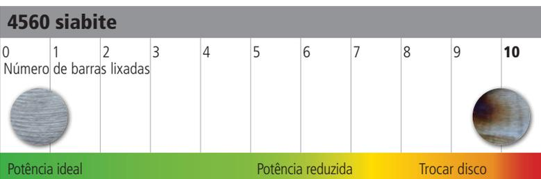
\* Testado em barras Inox Ø20mm, 10 s por barra. Teste manual. Prato de apoio Turbo II. Esmerilhadeira 1100W.
